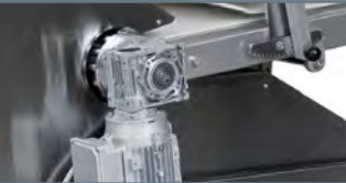
Independent engine of the belt Motorizzazione indipendente del tappeto.
