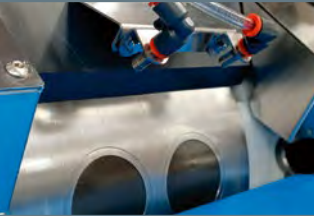
Extraction system through compressed air Sistema di estrazione ad aria compressa
